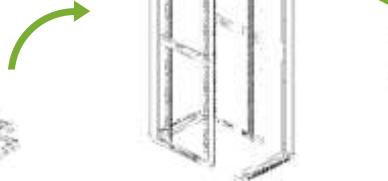
2A. Соберите раму (только для шкафов шириной 600 мм). Винты и гайки M6 – 12 шт.
